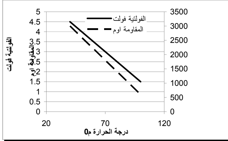
الشكل رقم (٤): يوضح العلاقة ما بين درجة حرارة المحرك وفولتية الحاسوب ومقاومة المتحسس.
