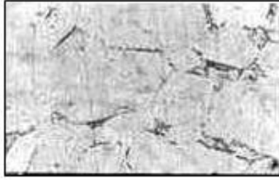
التركيب المجهرى للصلب الملحوم بالقوس الكهربائي بتيار (20 أمبير).
