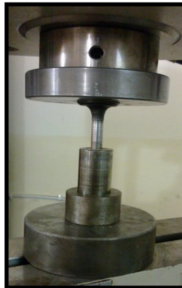
الشكل (1) يبين القالب المستخدم في عملية الكبس.
